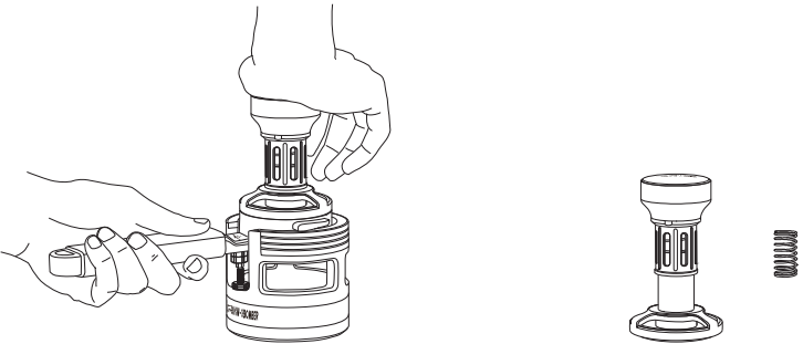
自動高さ調整 (タンピングに適し た最高寸法は13mm)
