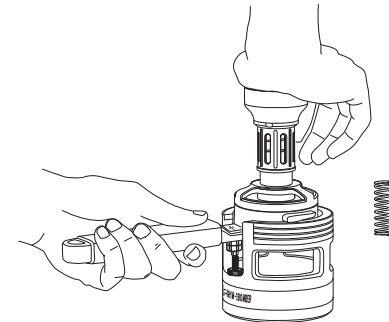
Impakt-Tampem (Wenn ein akustisches Feedback ertönt, ist das Tampem abgeschlossen)
